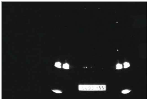
Figura 8: Matrícula sobre iluminada
