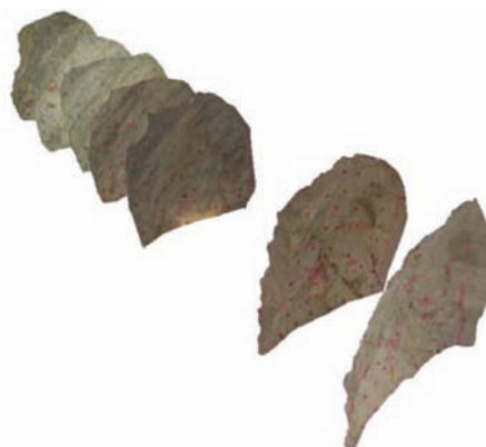
Figura 12. Documentación de frentes durante la excavación de un túnel.
