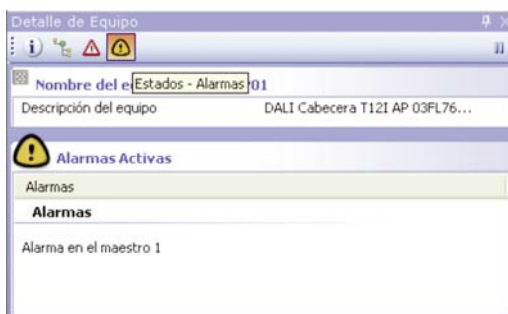
Pantalla de alarmas de un controlador DALI
