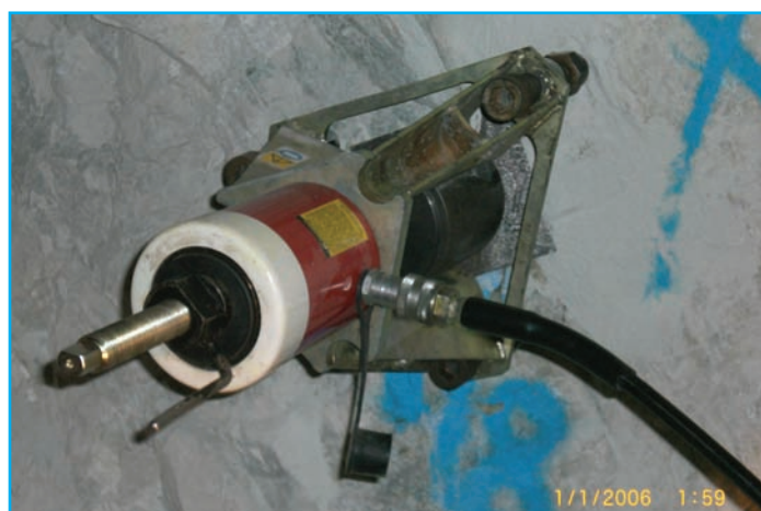
Gato de tracción para extracción de pernos Swellex
