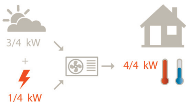
Esquema funcionamiento de una Bomba de Calor
