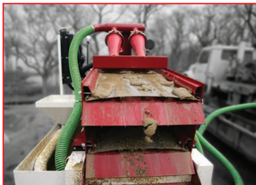
Efecto “masa de pan” en una criba vibratoria con rotación de un MudPuppy
