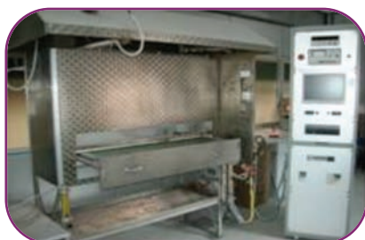
(izda) Dispositivo de panel radiante. (dcha) Muestra de una mezcla bituminosa preparada para el ensayo.
